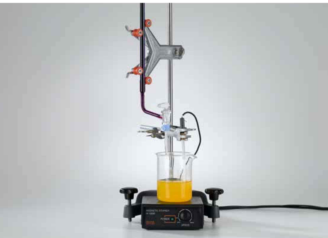
Potentiometric titration of iron(II) ions (C3.5.1.3)
